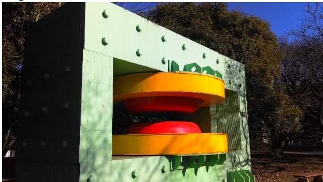
Der Elektromagnet des 4ten Zyklotrons, das von 1966-90 in Betrieb war. Ausgestellt vor dem Hauptgebäude des RIKEN, Wako.
