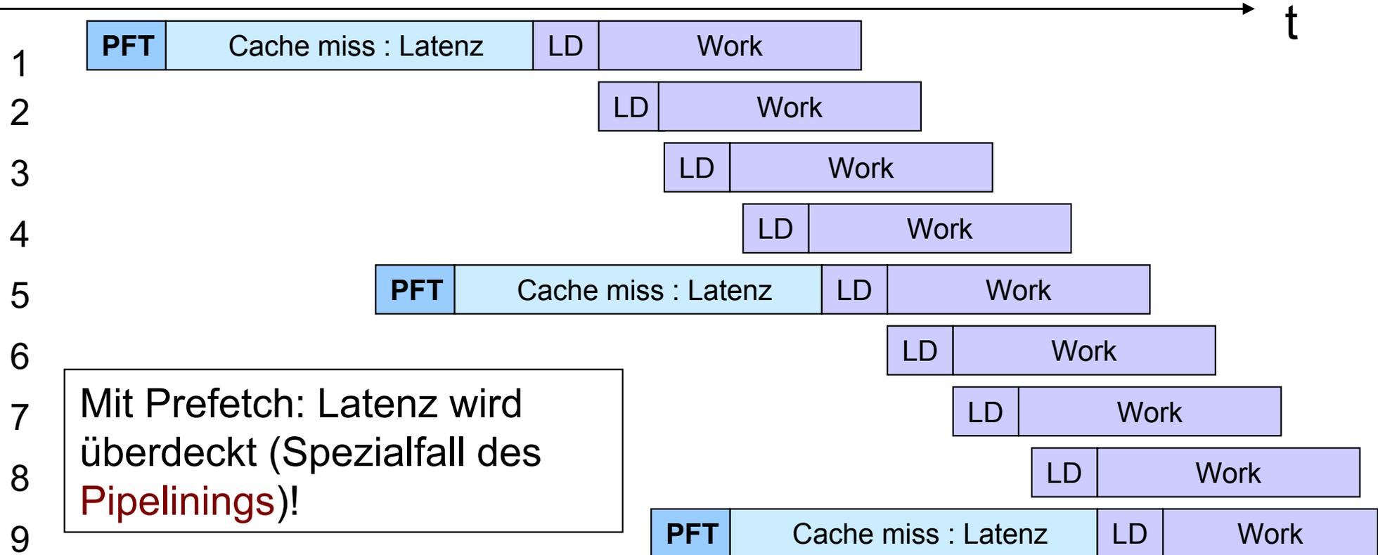
Mit Prefetch: Latenz wird überdeckt (Spezialfall des **Pipelining**s)!
